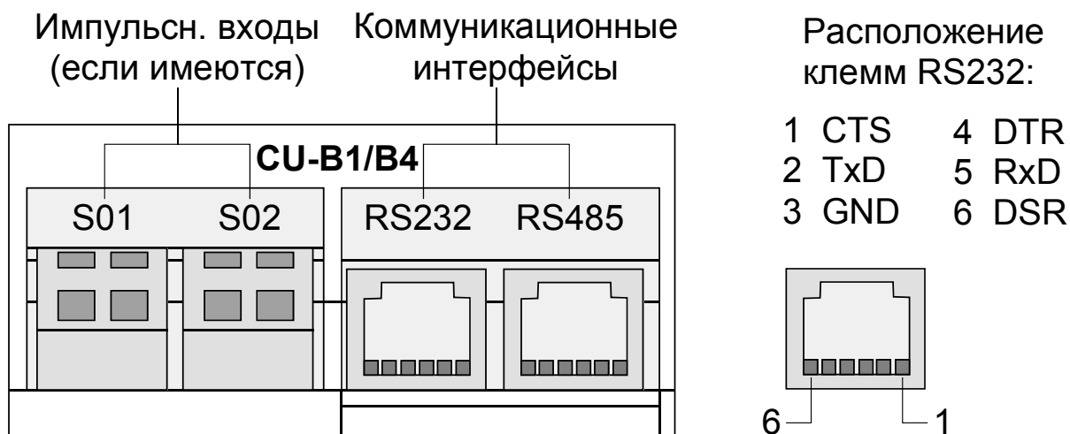
Рисунок 8 - Внешнее подключение коммуникационного модуля CU-B1/B4
